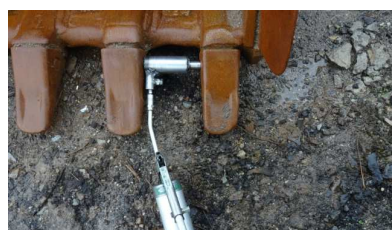
ピン抜き作業の高 圧駆動治具
