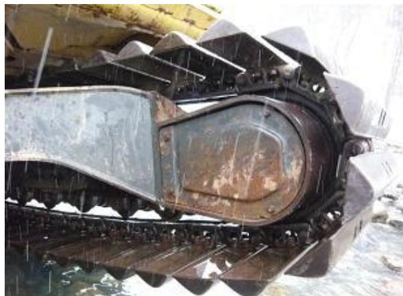
写真3 クローラ駆動部分のカバー
