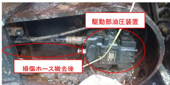
写真1 油圧ホースの撤去状況
