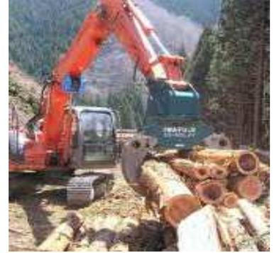
アタッチメントを解体用つかみ具、林業グラブと付替えて両方使用する場合は車両系建設機械として**特定自主検査**が必要となります
