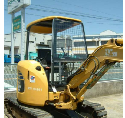
ミニショベル用簡易フロントガード: 取り付ける人が安全に付けやすく、多様なミニショベルに使いまわしでき、構成部品は現地調達しやすい、適法のもの(平成27年度考案)
