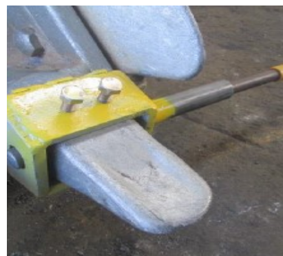
バケットツースピン抜き用の安全グリップ: 工具をボルトと爪で固定させ一人で叩く(平成28年度考案賞応募作品)
