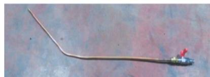
曲がるノズル：ノズルを鉄製でなく銅製にすることで形を自由に変えて、ミニショベルのラジエター周りの清掃を容易にした。(28年度考案賞応募作品)
